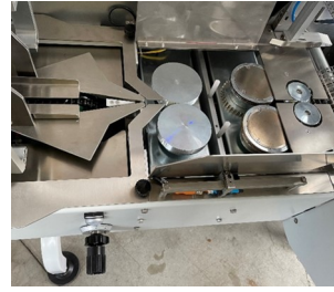
Einstellbare Neigung des ersten Rollenpaares
