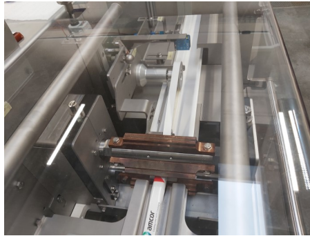
Mitlaufende Quersiegel- backen für Heißsiegel- anwendungen
